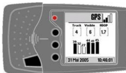
Cet écran reprend aussi les satellites visibles sous la forme de barres blanches et les satellites utilisés sous la forme de barres noires. Le nombre situé au dessus de chaque barre donne une indication du niveau de réception du satellite en question.
