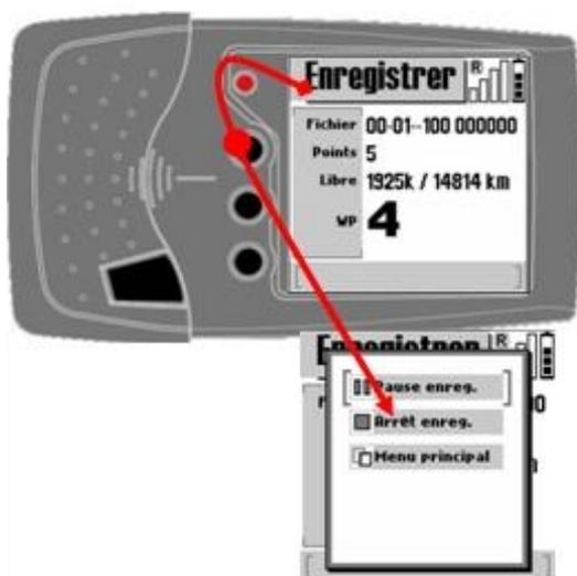
La manière la plus simple de mettre un enregistrement en pause est de mettre l'appareil en veille par la touche ON/OFF (1). Dès son redémarrage, l'appareil recommencera à enregistrer à l'endroit où vous l'avez éteint.
