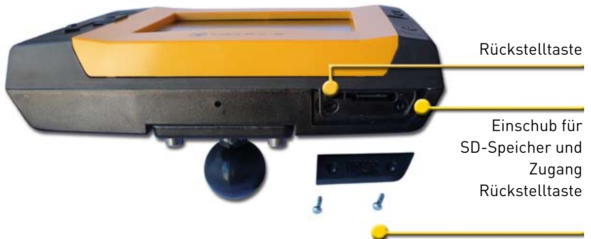
Schrauben für Abdeckung von Speicherkarte und Rückstelltaste
